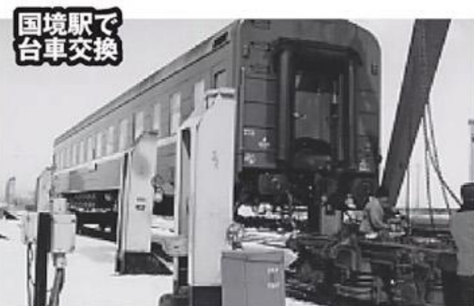
中国とロシアの国境駅で客車の台車を変更する。入国審査と合わせて3時間以上停車する
