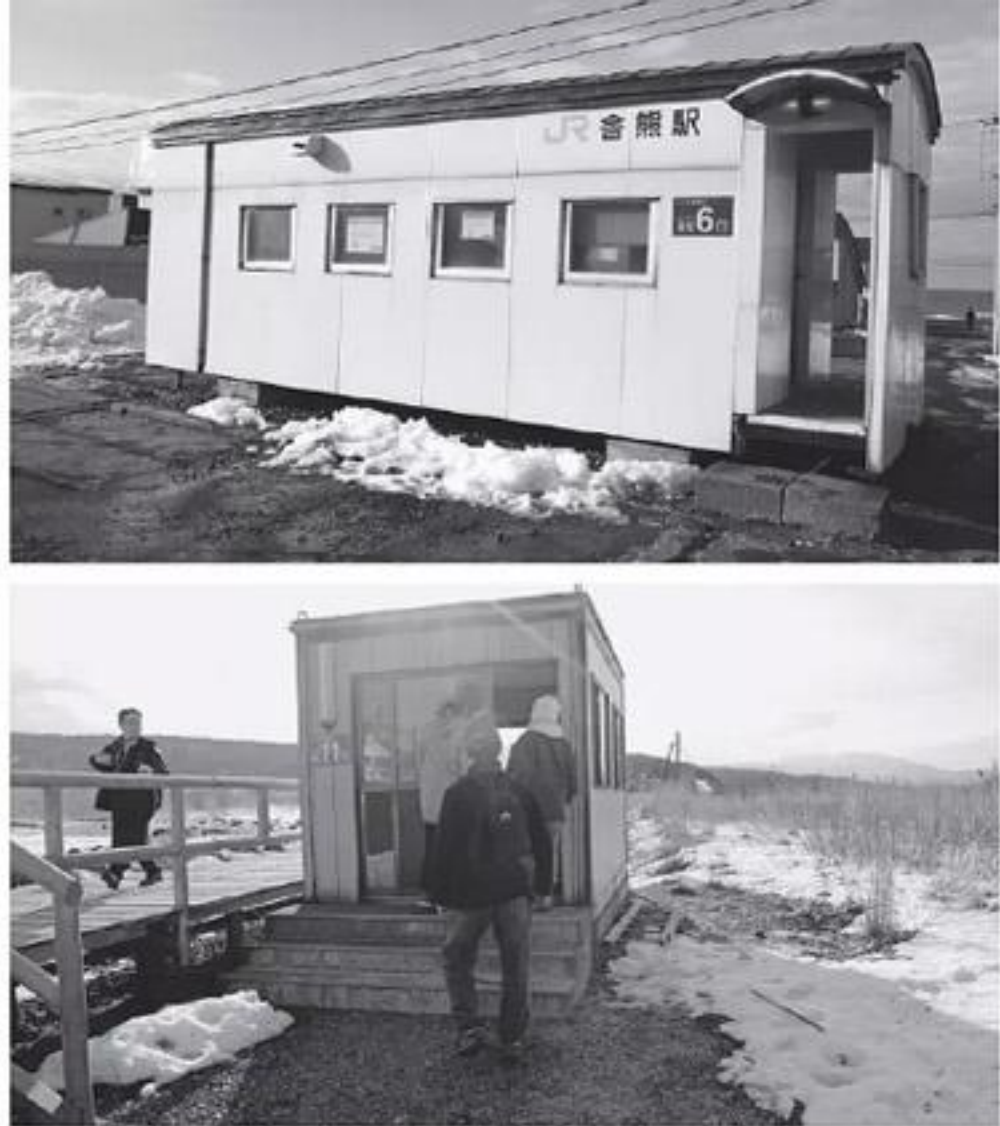
車掌車を再利用して作られた会館駅の待合室。鉄オタなら窓の配置から一目瞭然(上)。信砂駅の待合室はただのプレハブ(下)
